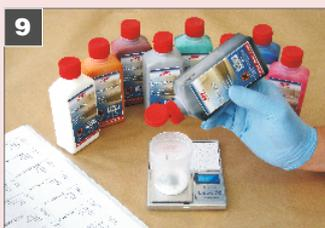
9 Mélanger les quantités appropriées de pigments inclus dans la couleur sélectionnée en utilisant une balance de précision.
