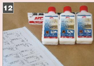
12 Si, selon les informations incluses dans la formule, une couche transparente doit être appliquée sur le dessus, cela doit être fait maintenant. Si un degré de ternissement différent de celui obtenu est nécessaire, il peut être ajusté en pulvérisant deux couches de vernis transparent approprié à l'effet recherché. NTW L-Mirror - mat, NTW S-Gloss - semi-mat, NTW H-Gloss - brillant.
