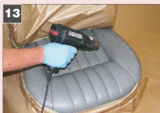
13 Après la mise de la dernière couche et le temps d'attente de 10 minutes, il est permis de sécher soigneusement à l'aide d'un pistolet thermique. Ne pas chauffer la zone au-dessus de 60°C, ne pas chauffer de 30 minutes.
