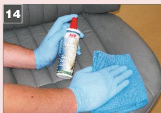
14 Lors de la réparation des surfaces en cuir, 2-3 heures après l'application du vernis, utiliser la préparation d'entretien pour le cuir Leather Care. Vaporiser un chiffon en microfibre par cette préparation et frotter doucement dans un élément réparé.
