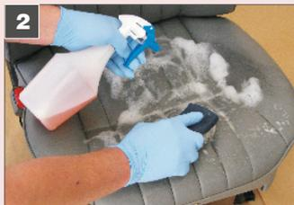
2 Les surfaces sur lesquelles le système NTW KOLOR doit être appliqué, doivent être propres et sèches. A cette fin, il faut les nettoyer avec Inner Cleaner dilué dans l'eau dans un rapport de 1:4 (sur le cuir de 1:10) et laisser sécher.
