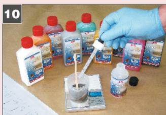
10 Ajouter la préparation NTW AP, augmentant l'adhésion du revêtement et augmentant la résistance aux produits chimiques de nettoyage ordinaires, au mélange obtenu. Ajouter 1,0 ml de NTW AP à la portion standard du vernis fini à l'aide de la pipette fournie. En règle générale, utiliser une addition d'environ 3% de NTW AP. La pipette doit être nettoyée à l'eau tiède.
