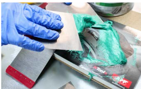
Mieszanie kitu szpachlowego z utwardzaczem
