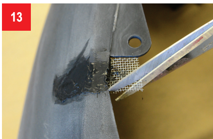
13 Выступающий кусок сетки отрезаем в виде т.н. „конверта“...
