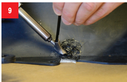
9 Связующее вещество вплавляем в поврежденное место по внутренней стороне повреждения.
