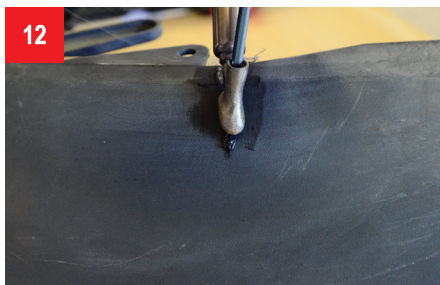
12 Связующее вещество вплавляем в поврежденное место, моделируя поверхность.
