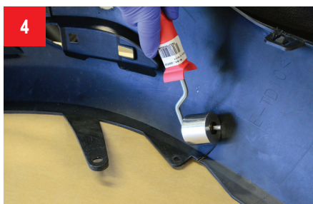
4 С помощью валика из комплекта разглаживаем возникшие неровности и коробления.
