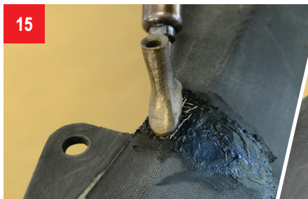
15 Запаиваем связующим, чтобы полностью покрыть алюминиевую сетку, окончательно моделируя ремонтируемую поверхность.
