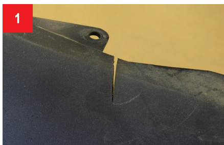
1 Осмотр повреждения и выбор технологии ремонта.
