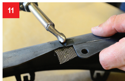
11 По внешней стороне повреждения готовим место для вплавляния связующего вещества.
