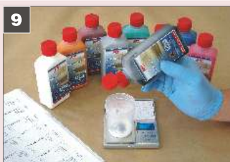
9 Смешать необходимое количество пигментов, входящих в состав определенного цвета, используя высокоточные весы.
