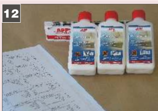
12 Если в формуле содержится информация о необходимости нанесения поверх слоя бесцветного лака, то необходимо это сделать сразу же. Если необходим другой уровень матовости, отличающийся от полученного, можно его скорректировать, нанося распылением два слоя соответствующего бесцветного лака до достижения желаемого эффекта. NTW L-Luster – матовый, NTW S-Gloss – полуматовый, NTW H-Gloss – блестящий
