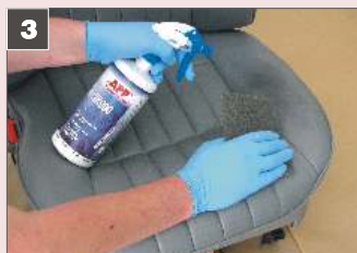
3 Обработать поверхность смывкой WK 900 и абразивным нетканым волокном. Это позволяет получить необходимую матовость поверхности.
