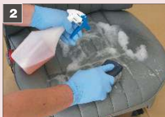
2 Поверхность, на которой будет использоваться система NTW Kolor, должна быть чистой и сухой. Чтобы этого достигнуть, необходимо очистить поверхность Inner Cleaner, разведенного с водой в пропорции 1:4 (для кожи 1:10) и высушить.
