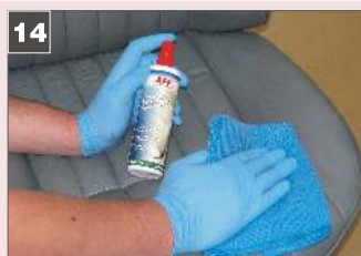
14 При восстановлении кожаных поверхностей после 2-3 часов с момента наложения лака необходимо нанести защитный препарат для кожи Leather Care. Сбрызнуть им салфетку из микрофибры и деликатно втереть в восстанавливаемый элемент.
