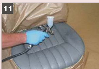
11 Лак наносится слоями: первый – тонкий, последующие – средне-мокрые. Между нанесением слоев следует подождать 5-10 минут для подсушки лака или можно ускорить процесс, осторожно используя технический фен. Для восстановления оригинального цвета достаточно трех слоев, но при необходимости можно увеличить количество слоев. При точечных восстановлениях следует использовать технику затенения. Высушить.
