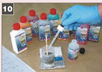
10 В полученную смесь добавить препарат NTW AP, увеличивающий адгезию к основанию и улучшающий устойчивость наносимого лака к воздействию химических средств. В стандартную порцию готового лака добавить 1,0 мл. NTW AP, используя прилагаемую пипетку. Как правило, рекомендуется использовать добавление 3 % NTW AP. Пипетку мыть теплой водой.
