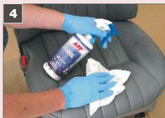
4 Удалить загрязнения очистителем и повторно обработать поверхность смывкой WK 900 и очистителем.
